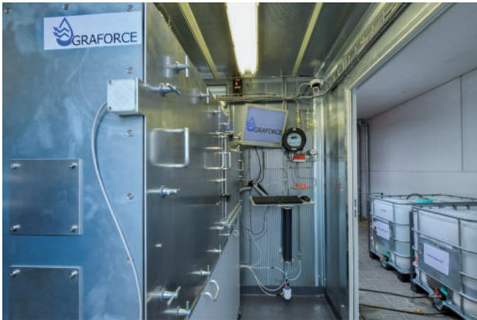
Abb. 2 Plasmalyseanlage
